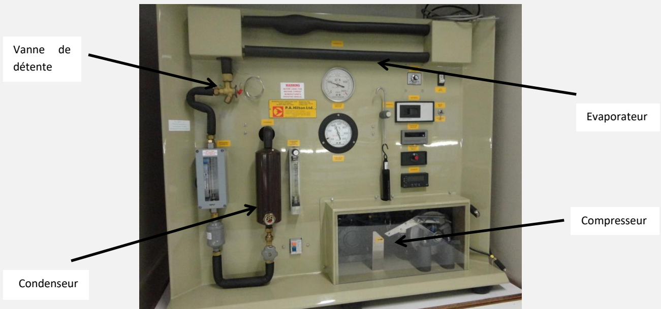
Photographie de « Refrigeration Laboratory Unit R714 », utilisant comme fluide frigorigène R134a
