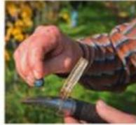
On réalise la mesure de l'indice de réfraction pour des solutions de pourcentage massique connu en sucre.
