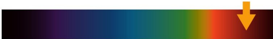
a Spectre continu de la lumière émise par un corps chaud à 3 500 °C
