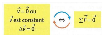
FIG. 5 Principe d'inertie.
