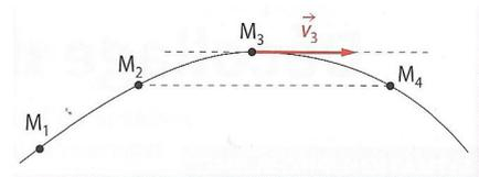
**FIG. 1** Le vecteur vitesse au point  $M_3$  est défini par  $\vec{v}_3 = \frac{\overrightarrow{M_2M_4}}{2 \cdot \Delta t}$ , tangent à la trajectoire.
