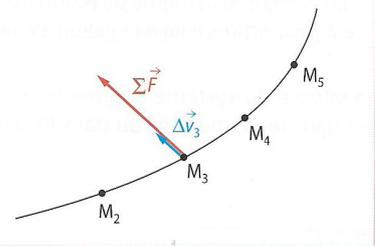
FIG. 7 Tracé du vecteur somme des forces.  $\Sigma\vec{F}$  et  $\Delta\vec{v}$  sont colinéaires et de même sens.
